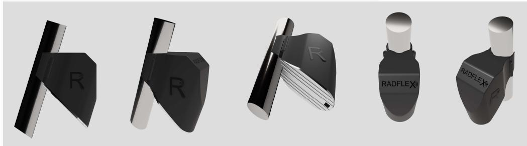
RADFLEX BRR är designad för att passa sadelstolpar med diameter 24-31 mm samt för aerodynamiska sadelstolpar. Reflektorn har en aerodynamiskt utformning och är designad för en extremt låg vikt, endast 25g med måtten 65x80x40mm. Reflektorn har ett inbyggt "klämfäste" för sadelstolpen samt två infästningar för en elastisk ring (ingår).
